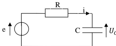
Dans ce circuit la tension  $U_C$  aux bornes du condensateur vérifie l'équation différentielle linéaire du premier ordre suivante :
