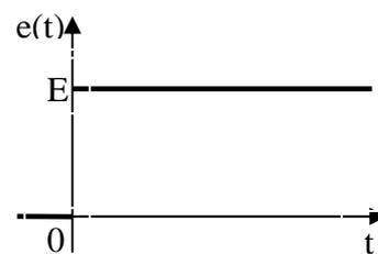
Pour  $t > 0$ , le condensateur est soumis à un échelon de tension montant et l'équation différentielle devient :  $\frac{dU_C}{dt} + \frac{U_C}{\tau} = \frac{E}{\tau}$  (second membre constant non nul).
