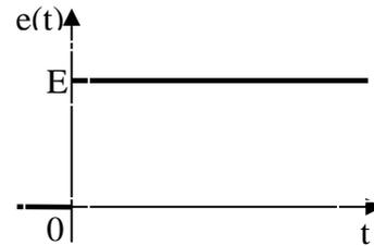
Pour  $t > 0$ , la bobine est soumise à un échelon de tension montant et l'équation différentielle devient :
