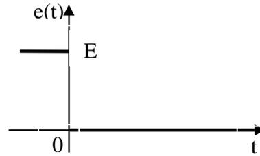
Pour  $t > 0$ , la bobine est soumise à un échelon de tension descendant et l'équation différentielle devient :
