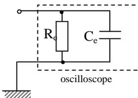
L'oscilloscope vu des 2 bornes d'entrée Y et masse est équivalent à une résistance  $R_e$  en parallèle avec un condensateur  $C_e$  :  $R_e$  désigne la résistance d'entrée de l'oscilloscope et  $C_e$  sa capacité d'entrée.
